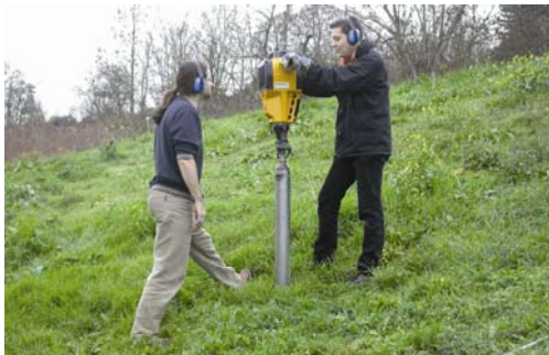
Erik Grüneberg (links) und Tim Walther (rechts) testen die Rammkernsonden für die Bodenbeprobung
